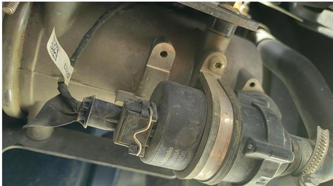
加热器解锁后可以正常启动，水泵正常工作，水泵工作时会有轻微振动
